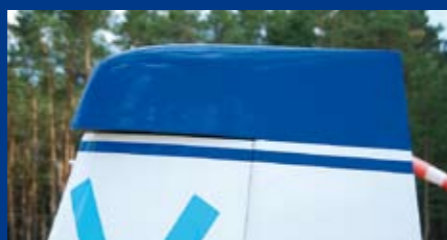
DIE LACKIERUNG kaschiert geschickt das große Seitenruderhorn.
