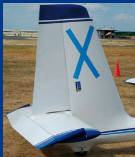
DIE LACKIERUNG kaschiert geschickt das große Seitenruderhorn.
