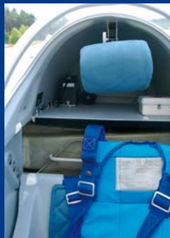
AUFGERÄUMTER Gepäckraum mit Notset, Akkuhalterung und einstellbarer Kopfstütze. Die Rückenlehne ist verstellbar.
